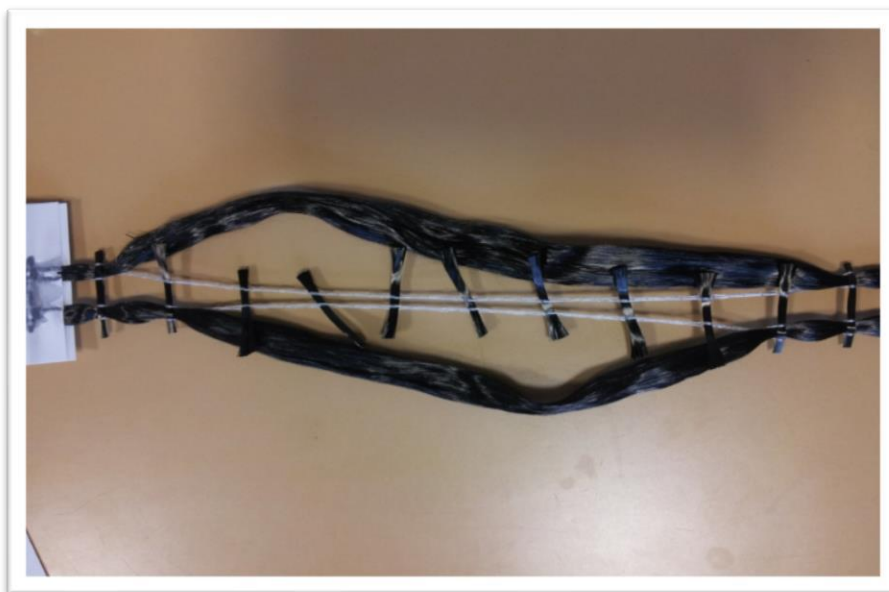
Obr. 3 Vzorek uhlíkových vláken o průřezu 3,4 mm 2 po zkoušce tahem.
