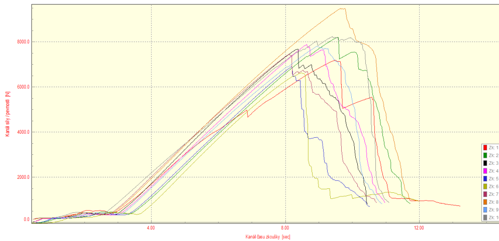
Obr. 10 Výstupní graf zkoušky tahem, závislost síly na deformaci.
