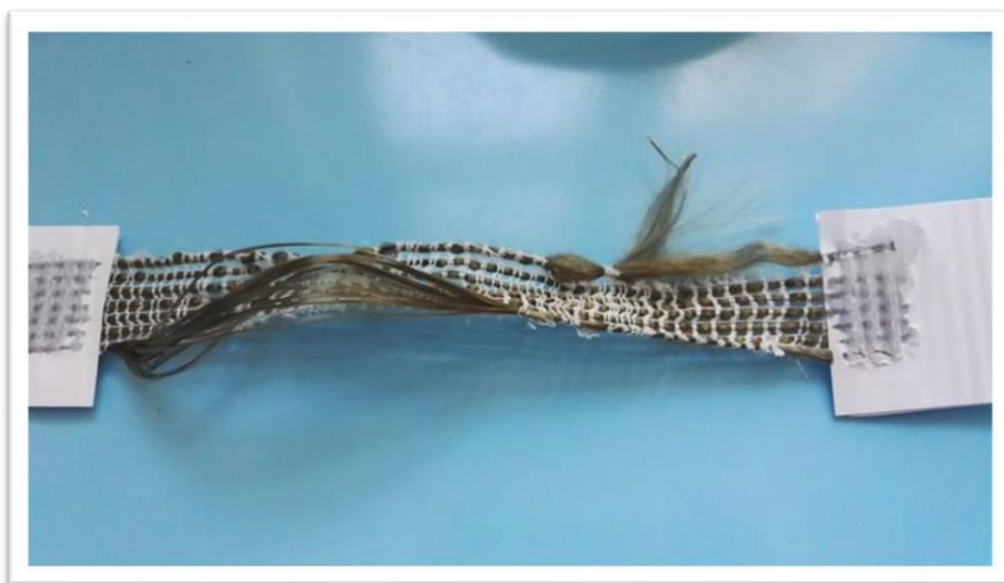
Obr. 9 Vzorek čedičových vláken po zkoušce tahem.
