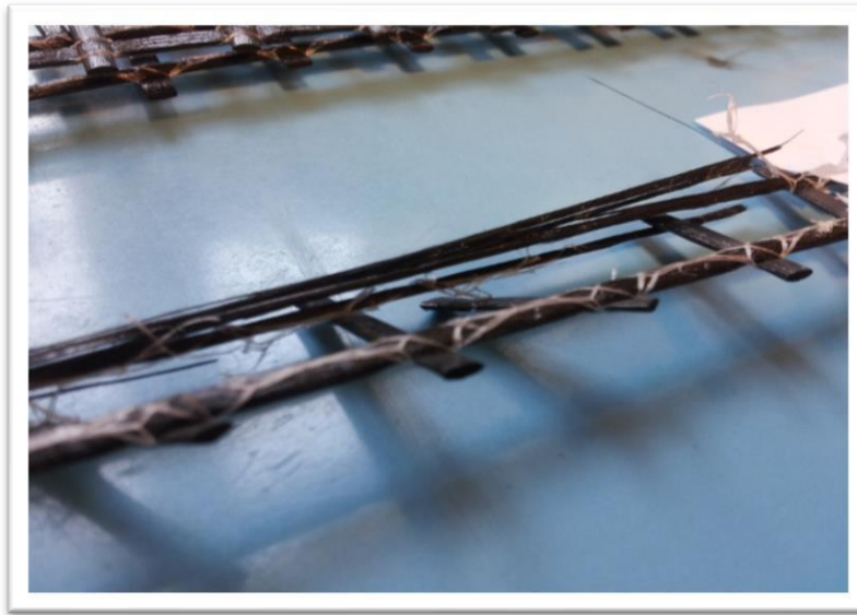
Obr. 7 Vzorek uhlíkových vláken o průřezu 3,4 mm 2 po zkoušce tahem.
